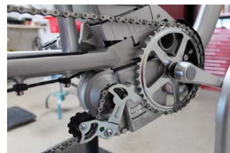
Der Panasonic-Antrieb von Flyer und Raleigh.
