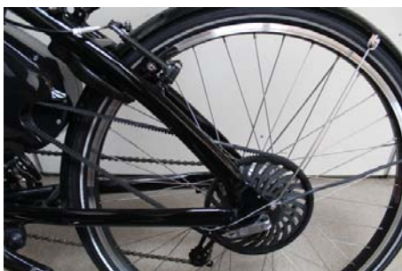
Beim Dolphin erfolgt der Antrieb via Zahnriemen.
